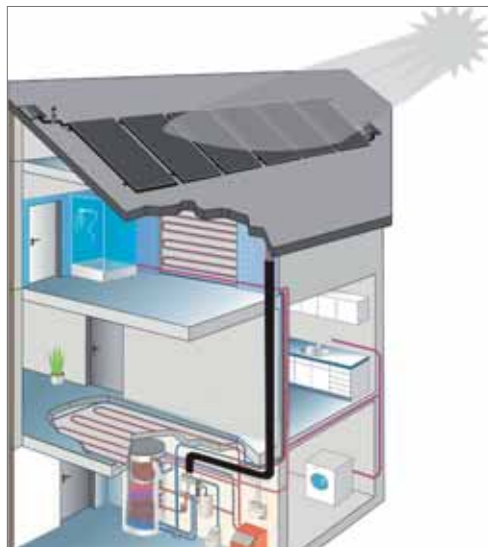
Funcionamento de uma instalação solar
